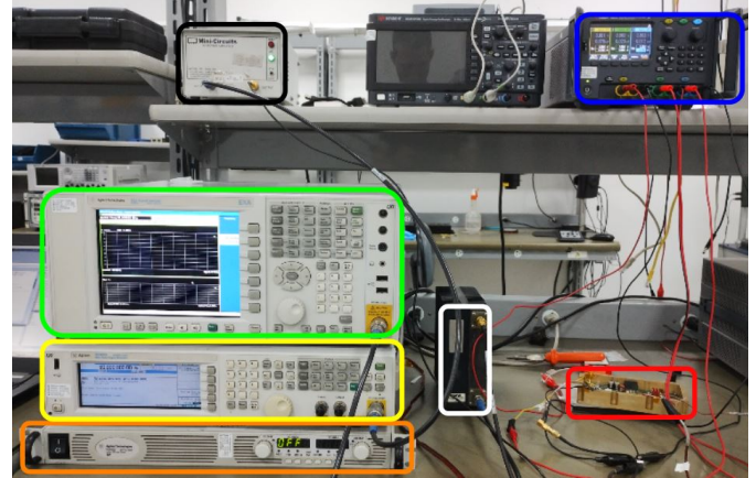
Fig. 3. Sistema laboratorial com os seguintes equipamentos: gerador de sinais (amarelo), amplificador de potência linear (preto), fonte Agilent Technologies N5767A (laranja), fonte Keysight E36313A (azul), amplificador de potência em teste (vermelho), atenuador de potência (branco) e analisador de espectro (verde).
